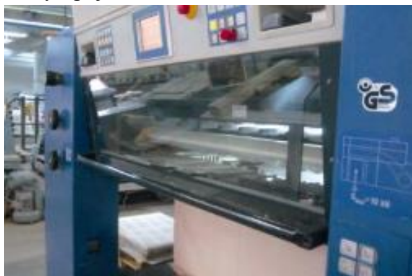
слика 32. - Заштитни поклопац на излагајућем ваљку
