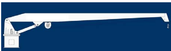
Слика 2.1 Кран са једним покретним делом [8]
