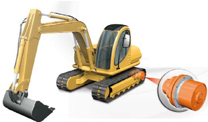
Слика 5.4.2 Платенарни преносник коришћен код багера [12]
