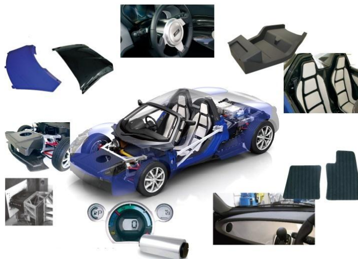
Слика 4.1 Делови аутомобила од композитних материјала
