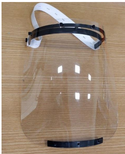
Слика 41. Пример израде заштитног визира
