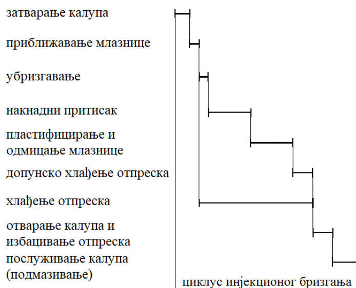
Слика 11. Циклус бризгања [5]
