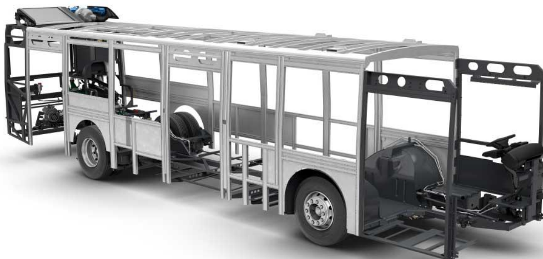
Слика 4.2 Шасија ОЦ 500 Л за Мерцедес Бенц [16]
