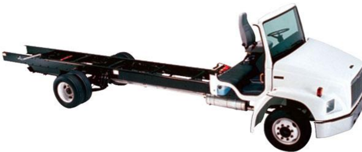
Слика 4.4 Рамна камионска шасија која се примењивала у почетку
