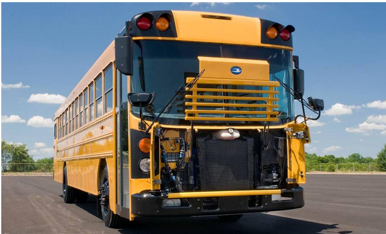
Слика 5.13 Аутобус са агрегатом напред
