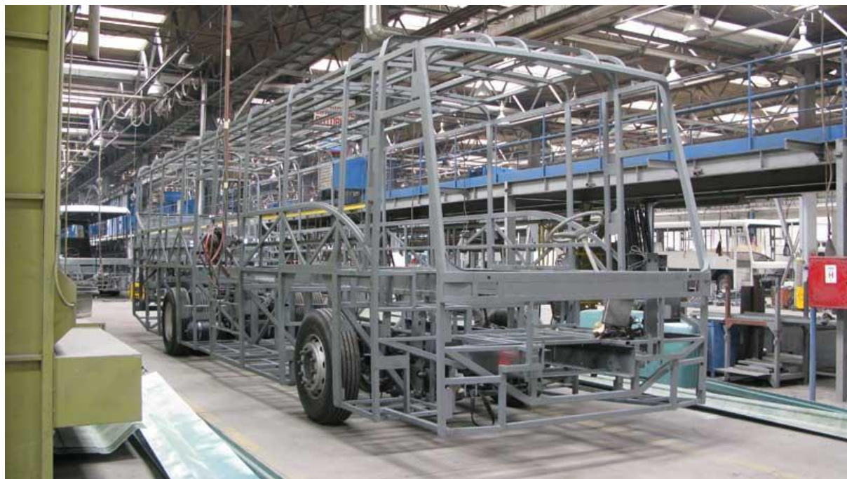
Слика 4.8 Носећа структура Неоплантовог Универса [10]
