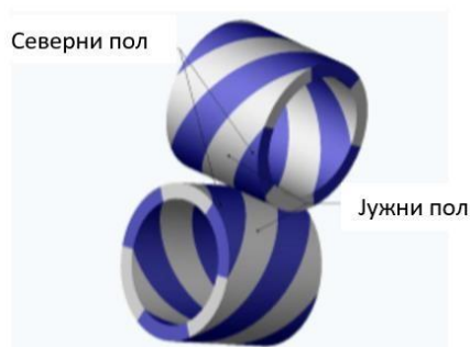
Слика 4.3.1.6 - Магнетни зупчasti преносници са мимоилазним осама [8]
