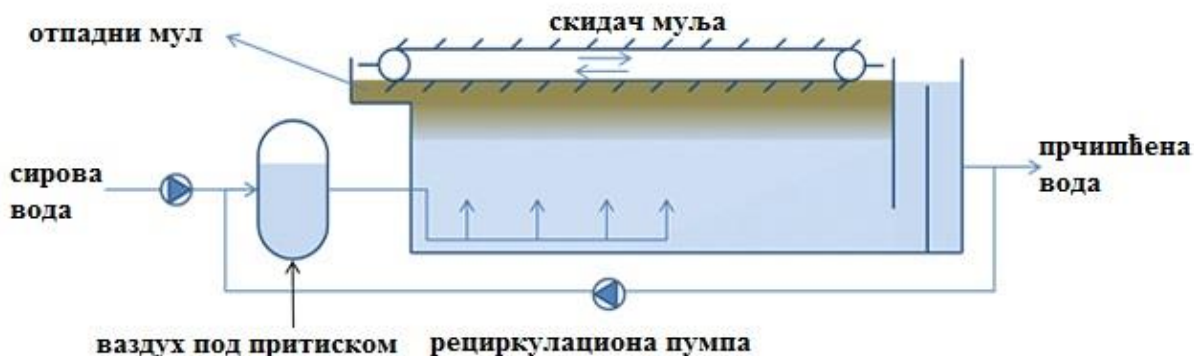
Слика 16 – Шема рада DAF система
