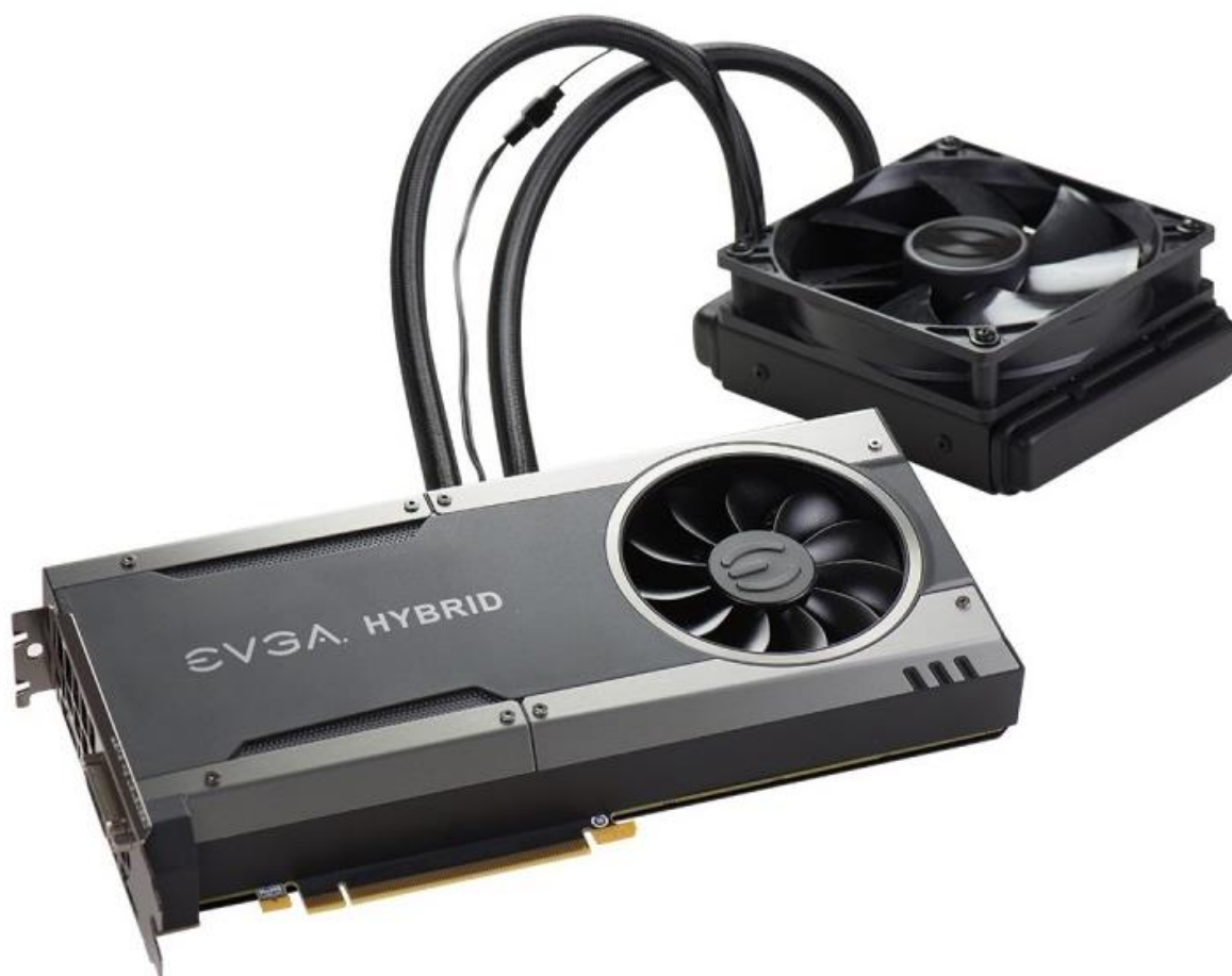
Слика 2.22 Систем хибридног хладњака (EVGA 1080 Hybrid)(overclockers.uk)
