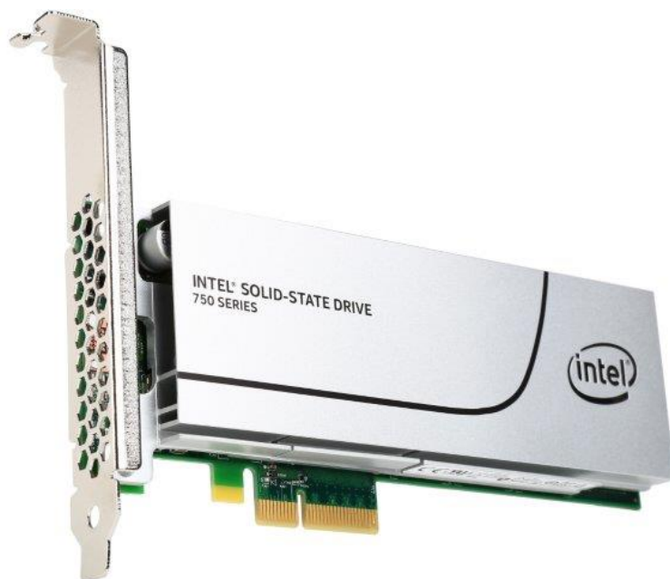
Слика 2.11 Пример PCIe SSDa (Intel 750 Series 400Gb)
