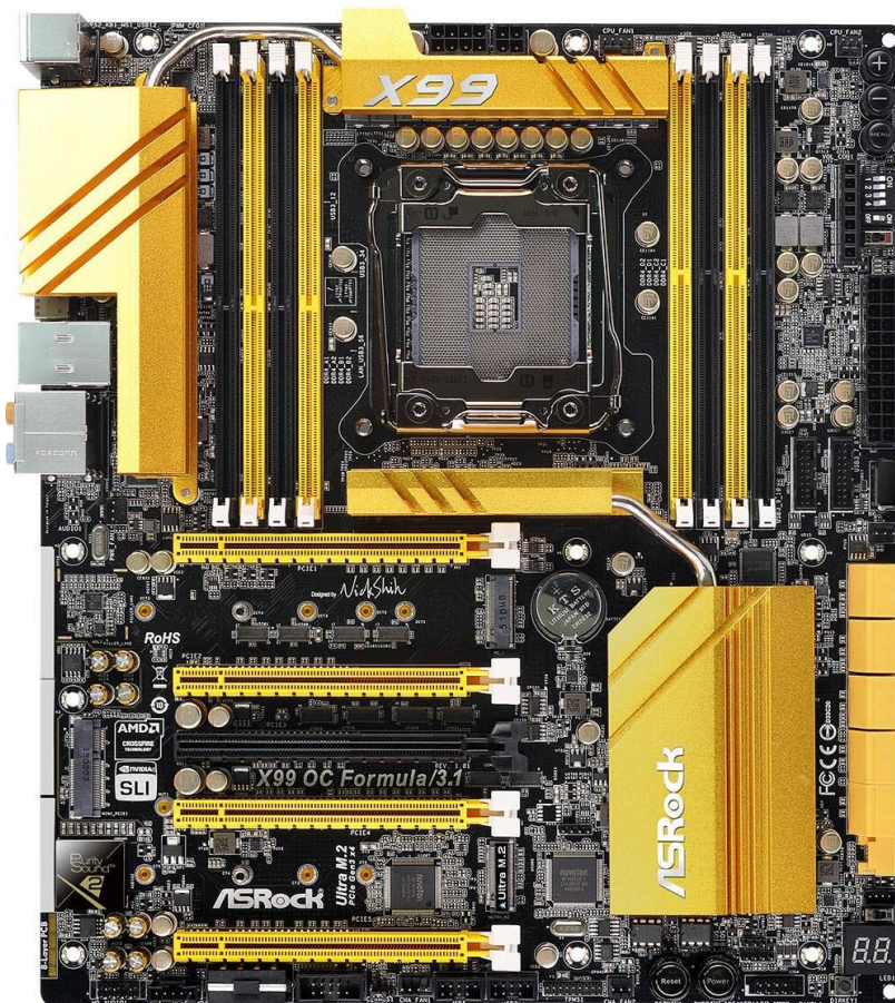
Слика 2.5 ATX матична плоча (ASRock X99 OC Formula 3.1)
