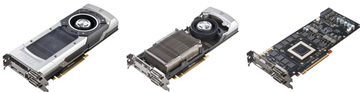
Слика 2.15 Издувни систем хлађења (nVidia GTX Titan 6Gb)(hexus.com)
