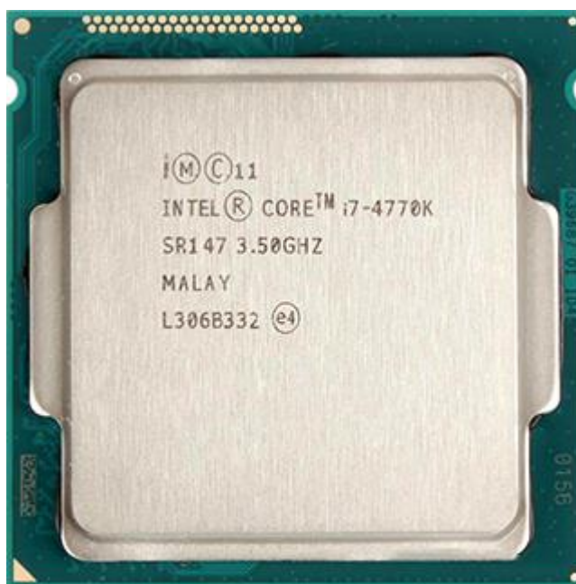
Слика 2.8 Централна процесорска јединица (Intel Core i7 4770K Haswell)
