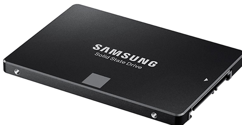
Слика 2.9 Пример SSDa од 2.5“ (Samsung 850 EVO)
