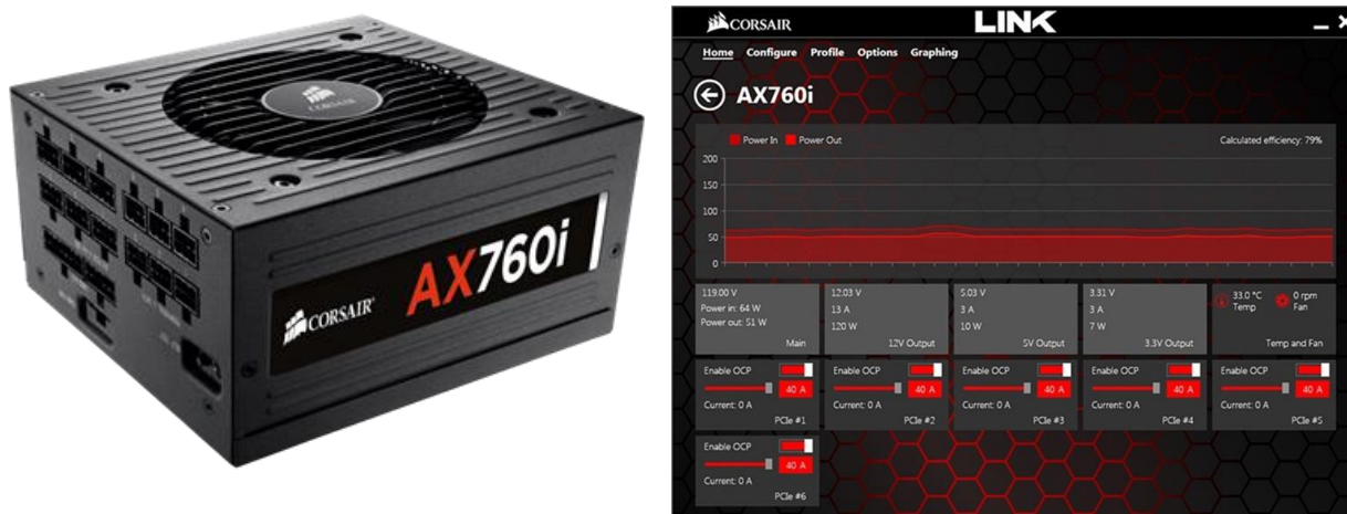
Слика. 2.25 Лево: Напајање Corsair AX760i Десно: Изглед софтвера за надгледање и контролу напајања
