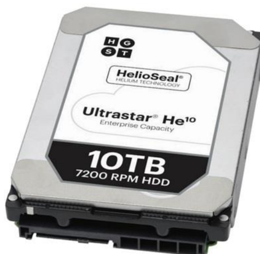
Слика 2.10 Хард диск високог капацитета испуњен хелијумом (HGST Ultrastar He10)
