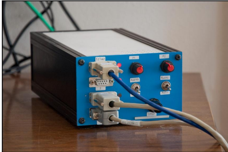
Слика 5. Појачавач снаге IPS 2M4SA/3
